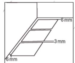
4. **Aplique correctamente el mortero:** Esparza mortero de pega sobre un área equivalente a dos piezas y cree surcos con la llana dentada, repita el procedimiento en la cara oculta del Producto. Inserte los separadores Clip entre las piezas.
